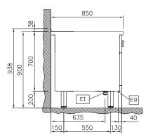
Electrical inlet (power) EQ Equipotential screw
